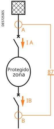
Fig. 1. Principio de protección diferencial.
